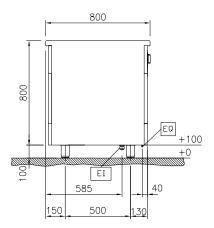
Electrical inlet (power) EQ Equipotential screw
